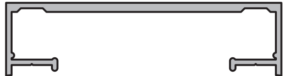
MARCO - PUERTA VAIVEN Perfil: 24 Peso: 0,730 Kg/m Matriz: M0693
