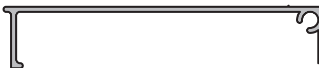
TAPACINTA Perfil: 521 Peso: 0,427 Kg/m Matriz: M1985
