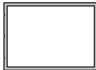
TRAVESAÑO INTERMEDIO Perfil: 527 Peso: 0,586 Kg/m Matriz: M2348
